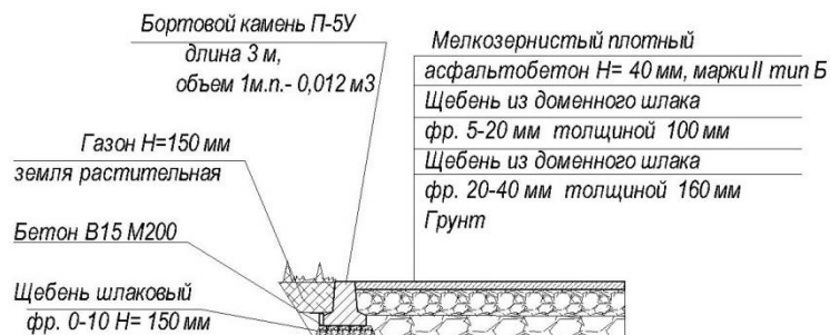
Схема 3 Конструкция покрытия тротуара Примыкание к газону
